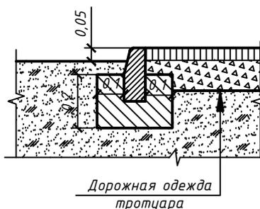
Схема понижения бортового камня при устройстве
