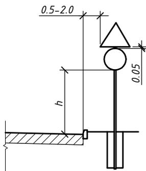
Верхний обрез фундамента опоры знака должен быть заподлицо с поверхностью присыпной бермы или земли.
