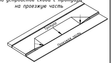
Схема понижения бортового камня в местах примыкания тротуара к проезжей части
